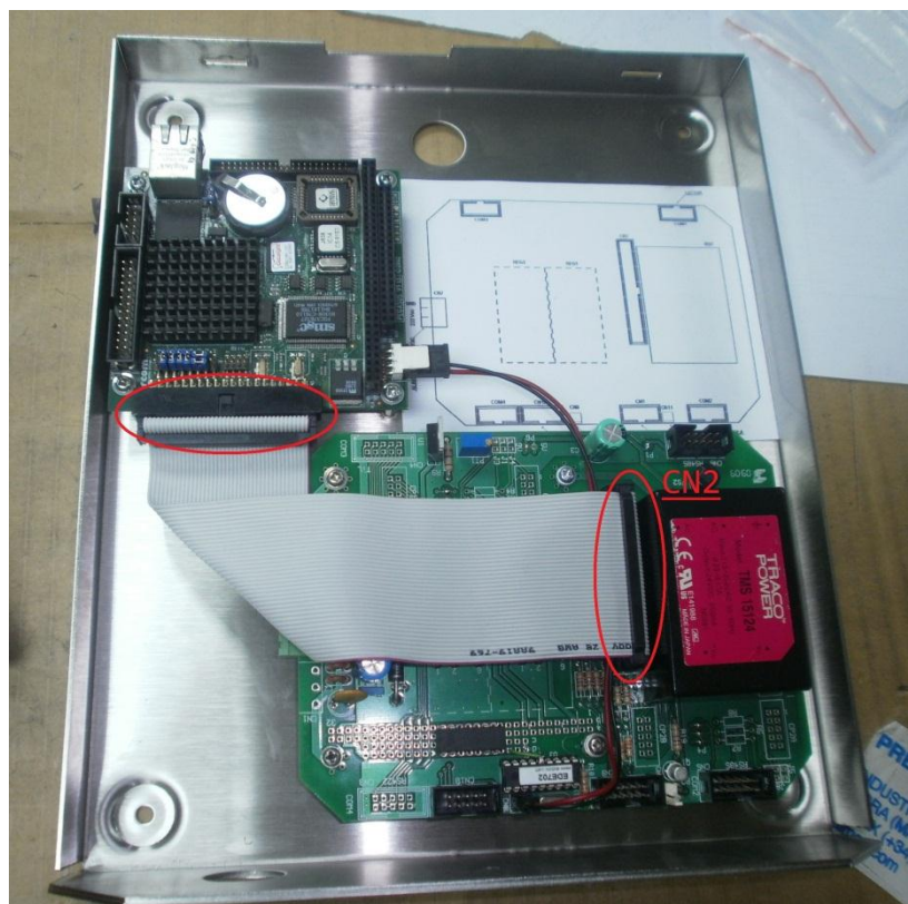
Figura 9.63 – Latiguillo salida de Puertos (CN2)
