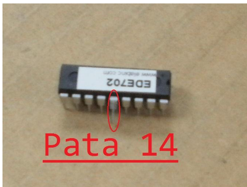
Figura 9.30 – Integrado 702 [Levantar Pata 14]
