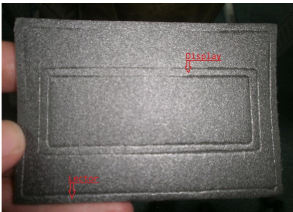
Figura 9.49 – Juntas de Estanqueidad (Display y Lector)
