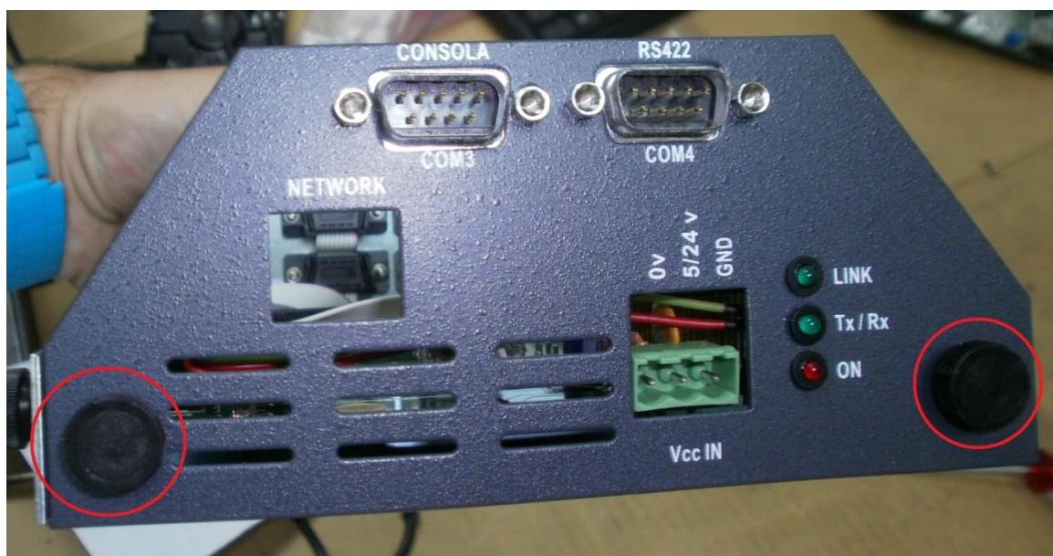
Figura 8.19 – Tapa de Arriba con los tornillos de rosca manual (Exterior).
