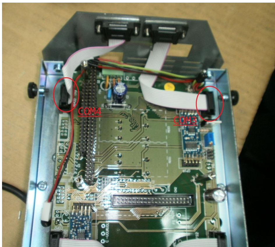
Figura 8.20 – Se conectan los conectores COM3 y COM4.
