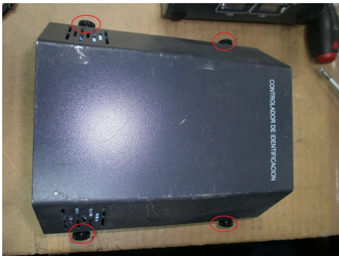
Figura 8.29 – Se sujeta la tapa con tornillos de rosca manual.
